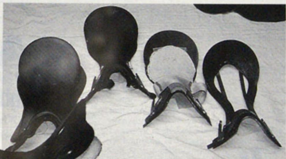
Sattelbäume in Holz, stahlverstärkt, teils gegurtet bzw. bereits mit Leder überspannt.
